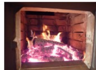
A metà combustione la centralina chiuderà automaticamente l'aria per ottimizzare la combustione. Attendere almeno 12 ore prima di ricaricare nuovamente la stufa
