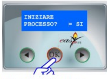
Selezionare SI/ dare OK/ poi tenere premuto ok per tornare MENU PRINCIPALE
